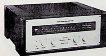
Stand 63 FM-stereoafstemmer. Vervorming mono < 0,1%, vervorming stereo < 0,1%. Prijs f 4350.
